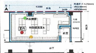
A-2 特別収蔵室 A 内の温度測定位置
