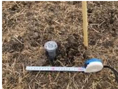
埋設された地下水位測定装置
